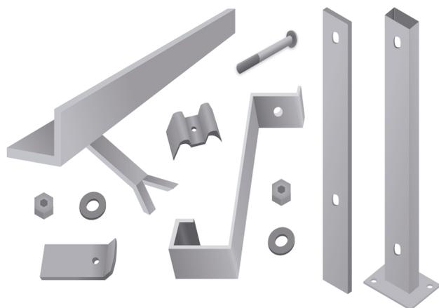
Os acessórios são produzidos para facilitar o manuseio e a manutenção feita pela mão de obra de instalação. São aplicados na fixação de grades de piso por meio de grampos para vigas I ou U; ou caixilhos com grapas. Para o gradil utilizam-se montantes (chumbados ou com sapatas). Podem ser galvanizados à fogo e/ou pintura eletrostática à pó.
