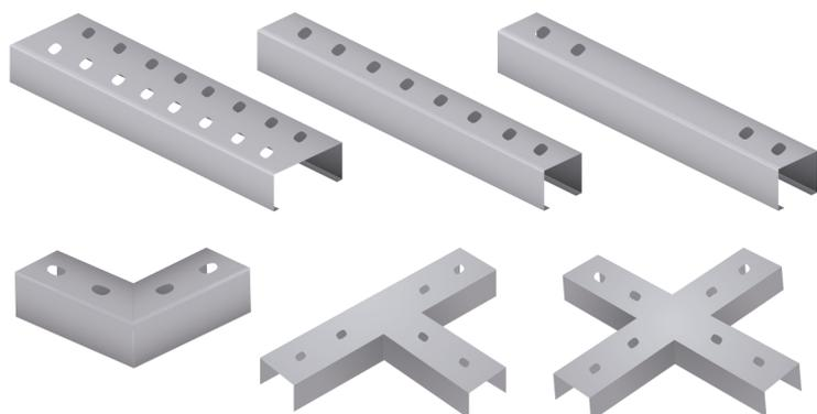
Os perfilados são estruturas de aço carbono pré-zincado, inox ou alumínio, utilizados na condução e distribuição de circuitos com pequena quantidade de fios e cabos, bem como para sustentação de luminárias.
